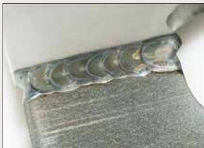
Schweißverbindung unterschiedlicher Metalle
